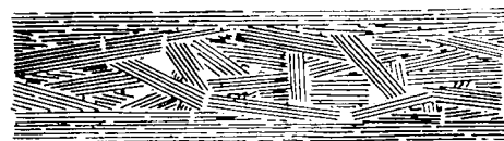
Lagerung der Makromoleküle abgebauter Fasern. (Durchschnittlicher Polymerisationsgrad 300.) (Durchmesser der zwischenmolekularen Spalten = 4–5 Å.)
